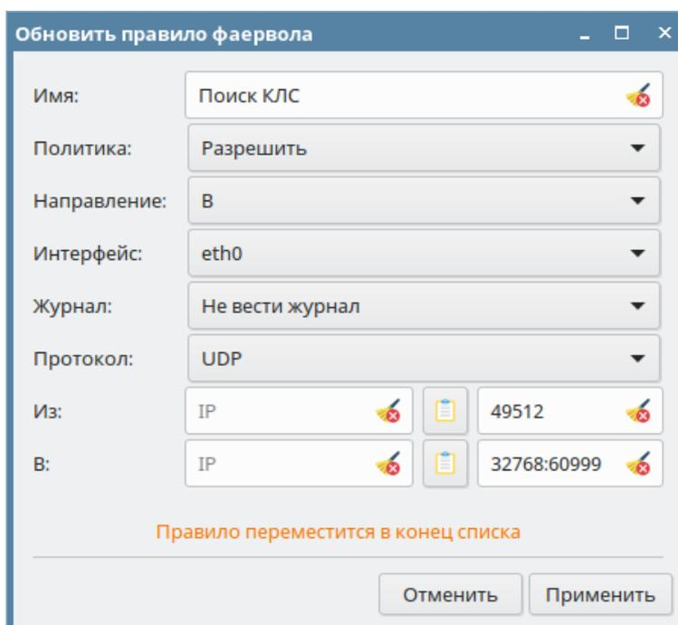
**Рис. 2** Вариант настройки разрешающего правила поиска сетевых КЛС
