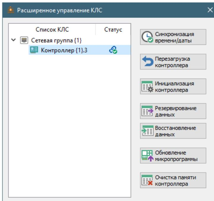
Рис. 22 Форма расширенного управления КЛС
